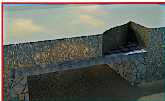
الزامات نصب ترافیکی : ● مش با میلگرد ۸ الی ۱۲ ● بتن به ضخامت ۵ الی ۱۰ سانتیمتر تعداد و سایز میلگرد و ضخامت بتن بستگی به طول قطعه و فشار وارده دارد
