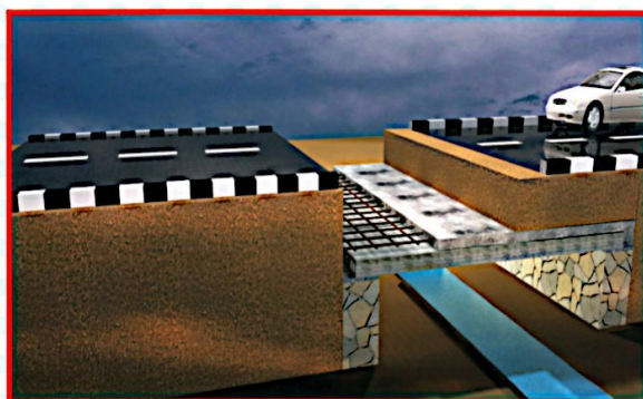
● جزئیات قرار گرفتن صفحه تو خالی برای ایجاد سوراخ و محل عبور تاسیسات و هواکش
