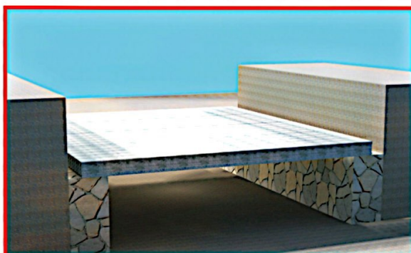
الزامات نصب ترافیکی : ● مش با میلگرد ۸ الی ۱۲ ● بتن به ضخامت ۵ الی ۱۰ سانتیمتر تعداد و سایز میلگرد و ضخامت بتن بستگی به طول قطعه و فشار وارده دارد
